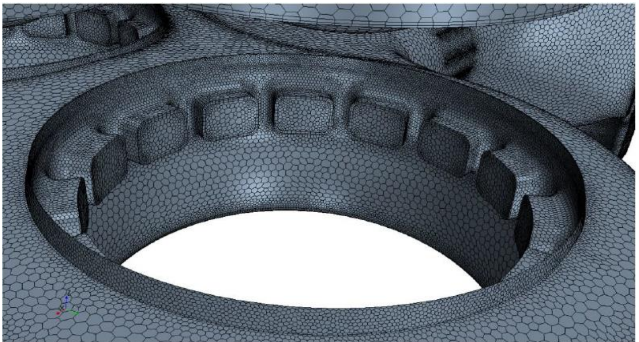
Figura 12. Detalle de las lumbreras de admisión en torno al cilindro, modeladas en una malla para su posterior simulación CFD.
