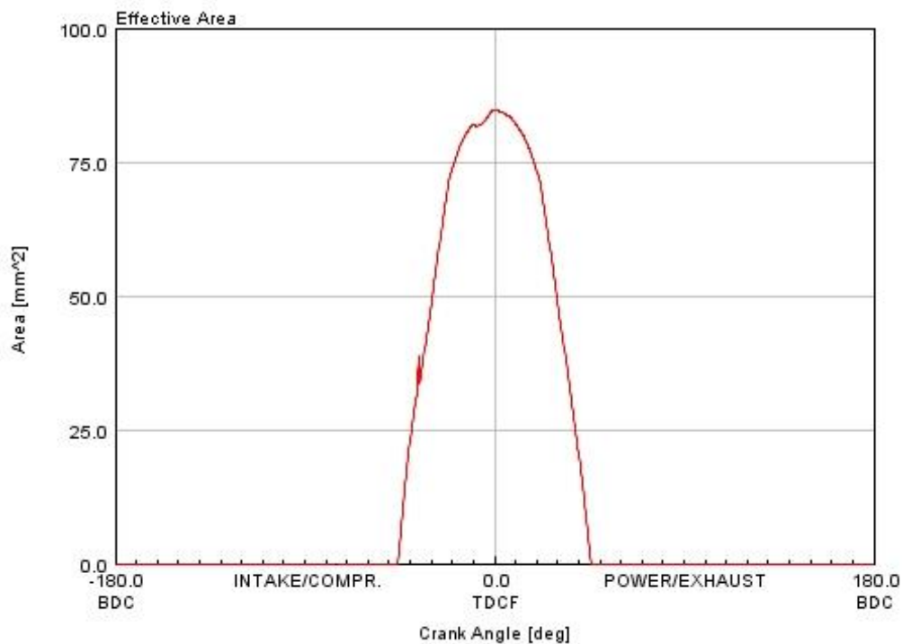
Figura 10. Área efectiva de una lumbrera en función del ángulo del cigüeñal.
